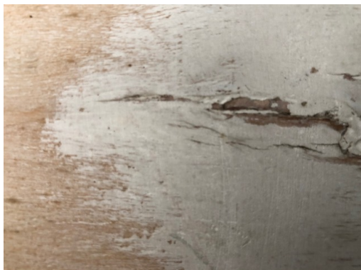
Traces d'enduit et fissures au revers du panneau
