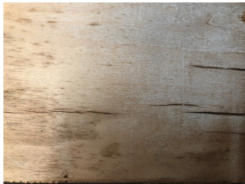
Traces d'enduit et fissures au revers du panneau
